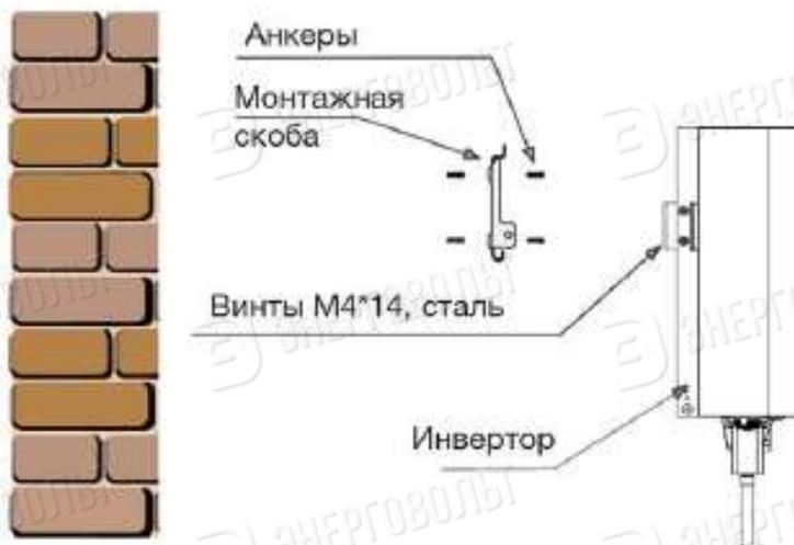
Рис. 4.4 Установка инвертора
