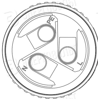
Рис. 5.9 Схема отверстий в коннекторе кабеля переменного тока
