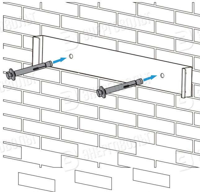
Рис. 4.5 Установка монтажной скобы
