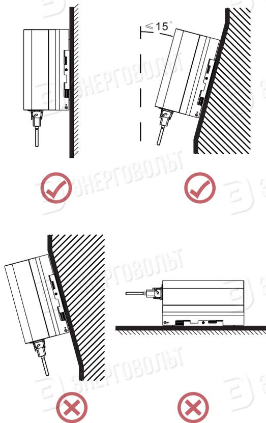
Рис. 4.2 Угол установки
