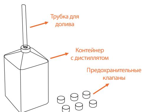
Шаг 4: Мягко выдавите дистиллят из контейнера полностью. Закройте предохранительный клапан, когда наполнение будет закончено.
