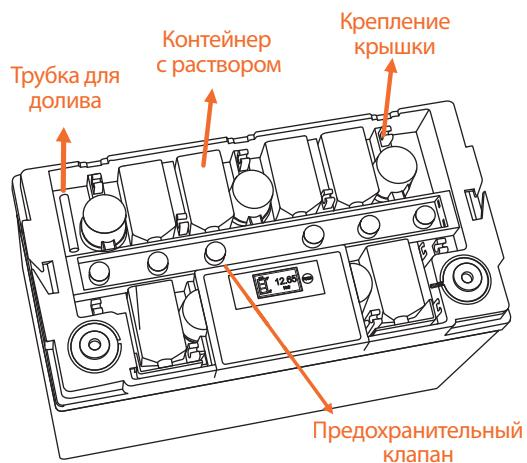
Шаг 3: Соедините трубку для долива с контейнером, затем соедините другую сторону трубы с одним из отверстий предохранительного клапана.
